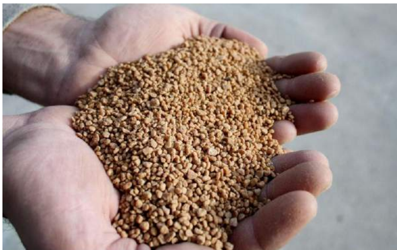
Figura 11 - Caroço de azeitona para ser utilizado em caldeira
